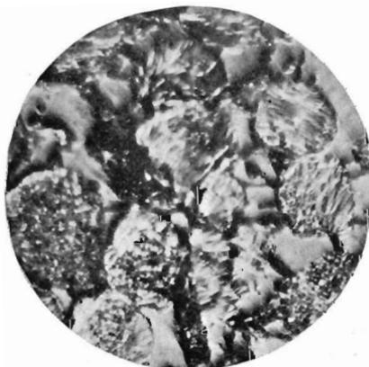
FIG. 32.—INGOT WITH TUNGSTEN-CARBIDE NETWORK SURROUNDING TUNGSTEN GRAINS.  $\times 950$ .
