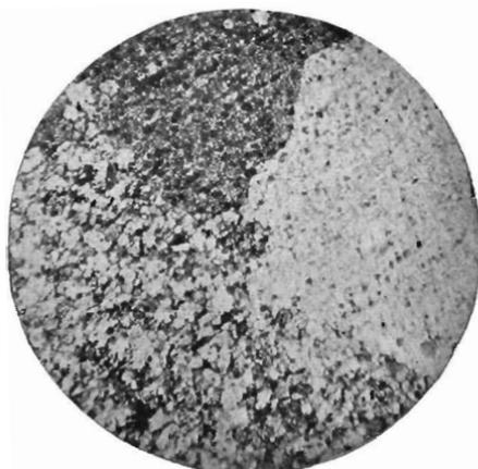
FIG. 20.—TUNGSTEN INGOT SHOWING TWO LARGE GRAINS IN POSITION TO ABSORB SMALL GRAINS.  $\times 117$ .
