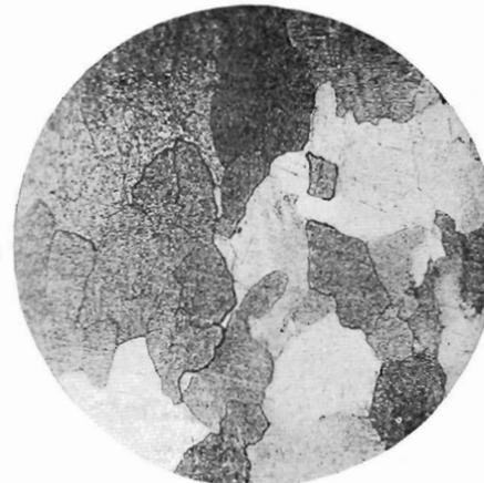
FIG. 37.—COARSE-GRAINED TUNGSTEN INGOT, SWAGED AND RECRYSTALLIZED.  $\times 74$ .
