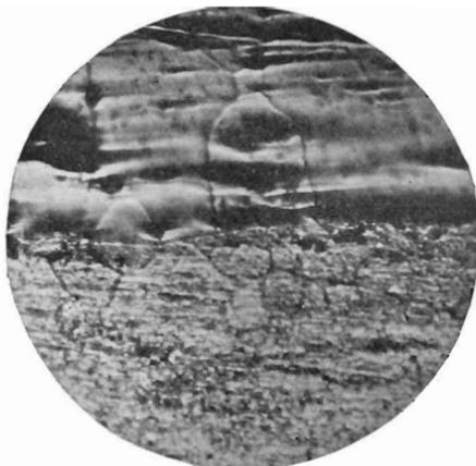
FIG. 35.—TUNGSTEN ROD CARBONIZED WITH HYDROCARBONS. LIGHT PORTION IS TUNGSTEN CARBIDE.  $\times 400$ .
