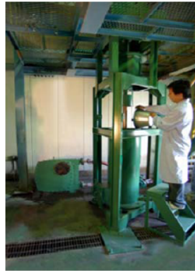
Model 型号 : KM-5 Tower Mill Capacity 容积 : 120 liter Sample 样品 : ~150 kg / test Test period 实验时间 : 2 weeks Purpose 目的 : Mill size selection for the performance warranty 设备选型实验
