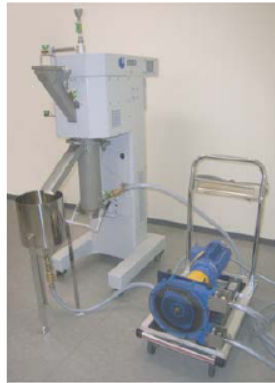
Model 型号 : NE008 Tower Mill Capacity 容积 : 8 liter Sample 样品 : ~10 kg / test Test period 实验时间 : 1 week Purpose 目的 : Preliminary grindability check 目的: 初步的易磨性检测
