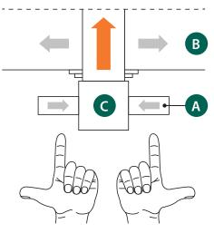
A) Bearing rollerB) KilnC) Carrying roller
